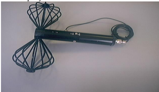
Рисунок 1 - Общий вид антенны дипольной активной П6-51
