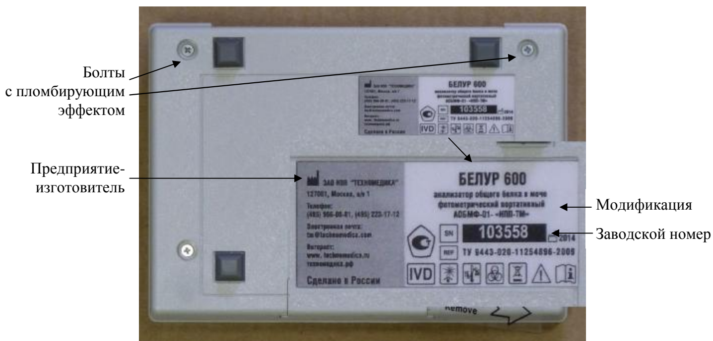
Рисунок 2 – Схема пломбировки от несанкционированного доступа и маркировки
