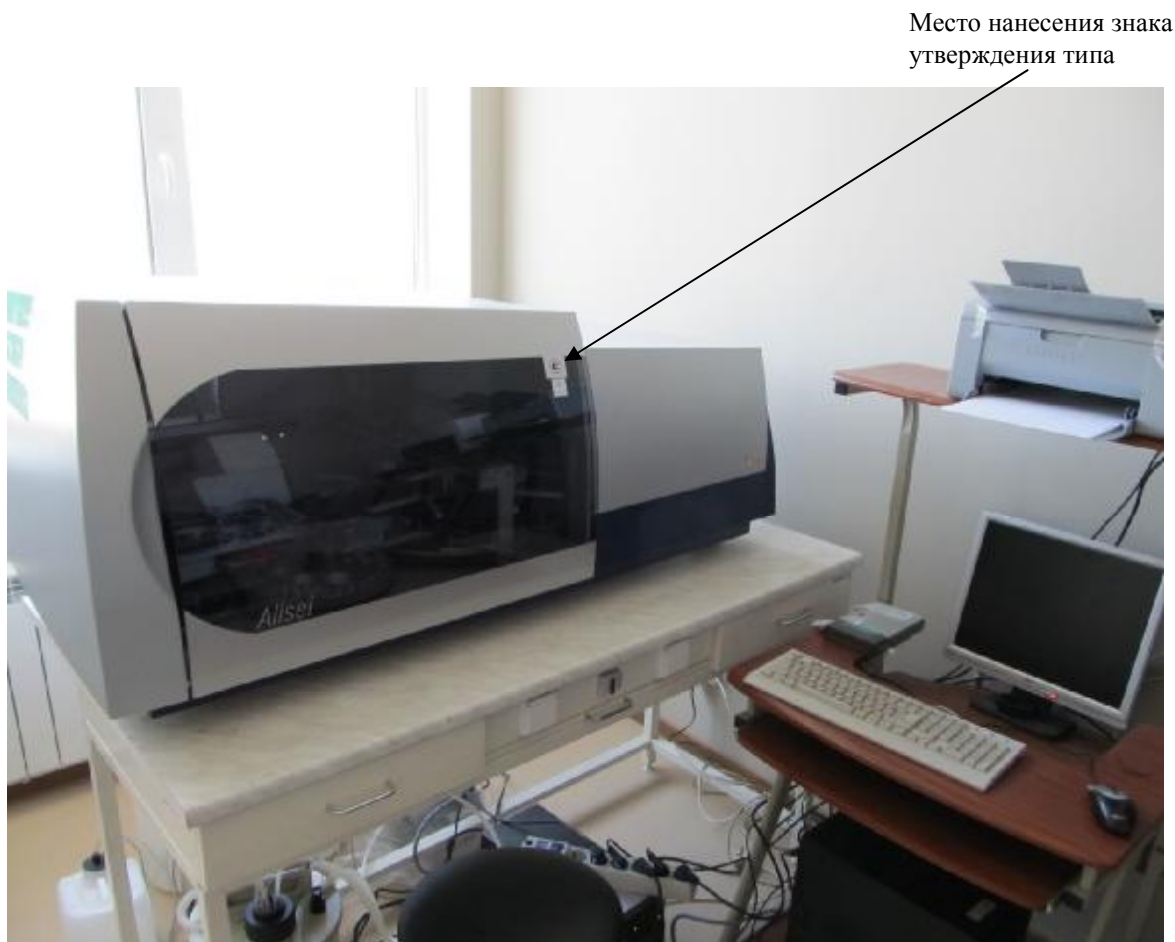
Рисунок 1. Общий вид системы для иммуноферментного анализа ALISEI и место нанесения знака утверждения типа
