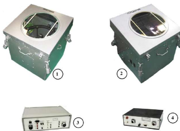
Рисунок 1 - Измеритель высоты облаков ДВО-2 1 - приемник, 2 - источник световых импульсов, 3 - блок измерительный, 4 - пульт дистанционный
