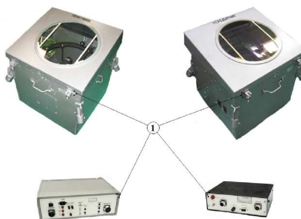
Рисунок 2 - Схема пломбирования ДВО-2. 1 - пломбы на источнике, приемнике, блоке измерительном, пульте дистанционном.
