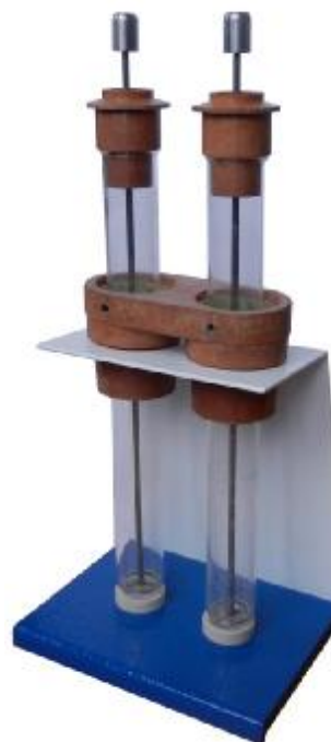
в) подставка для кассеты с кассетой, пробирками и шток-мешалками
