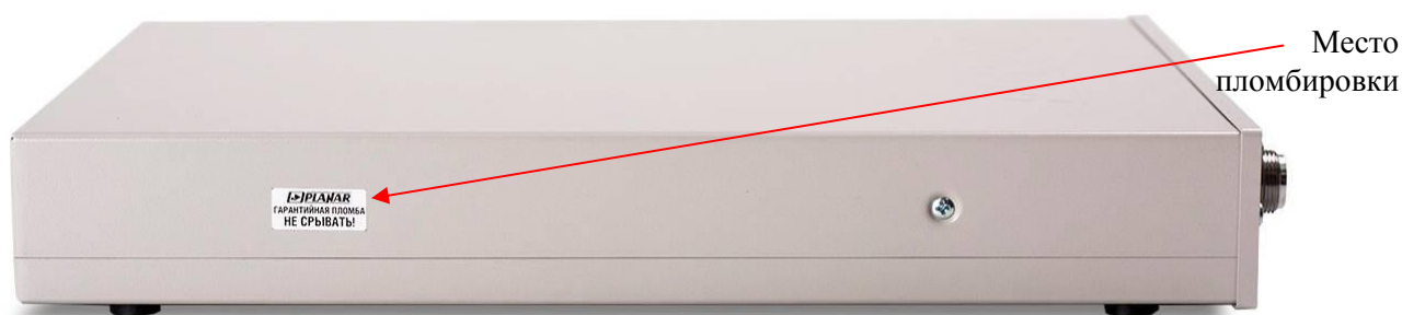
Рисунок 3 - Место пломбировки от несанкционированного доступа на боковой панели измерительного блока
