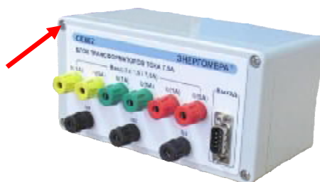
Рисунок 3 - Место пломбирования блока трансформаторов
