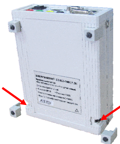
Рисунок 2 – Места пломбирования блока измерительного
