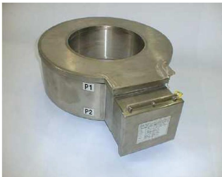
Трансформаторы тока состоят из металлического корпуса, внутри которого находятся одна или несколько (до пяти) вторичных обмоток - измерительных и/или защитных. Обмотки равномерно намотаны на ленточные торOIDальные магнитопроводы и покрыты эпоксидным компаундом. Возможно обеспечение одного, двух или трех коэффициентов трансформации. Первичной обмоткой является токоведущая шина внутри ввода. Выводы вторичных обмоток и вывод заземления расположены в коробке
