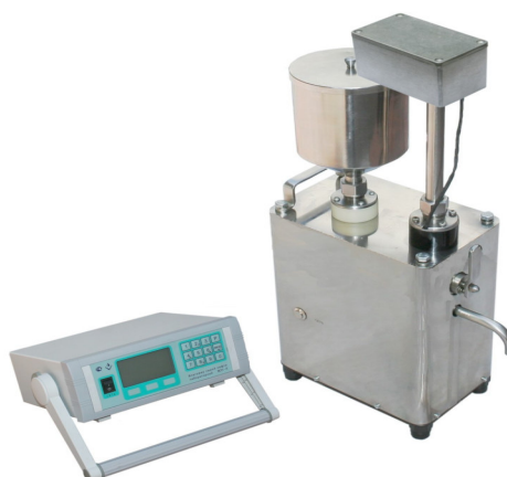
Рисунок 1 – Общий вид влагомеров сырой нефти лабораторных ВСН-Л-01 и ВСН-Л-02
