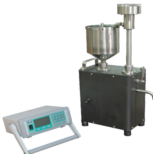
Рисунок 1 – Общий вид влагомеров сырой нефти лабораторных ВСН-Л-01 и ВСН-Л-02
