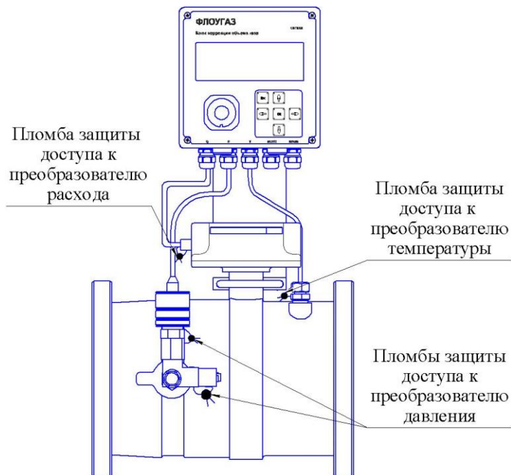
Рисунок 2 – Схема пломбировки комплекса
