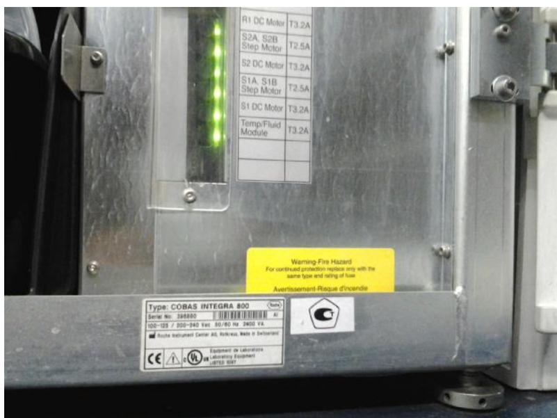
Рис.4 - Схема маркировки анализатора Cobas Integra 800
