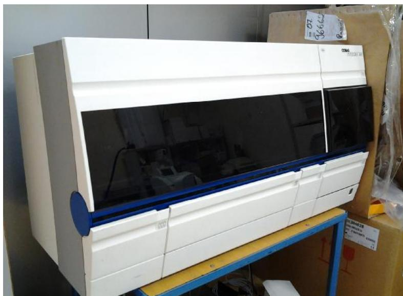
Рис. 1 - Анализатор биохимический автоматический Cobas Integra 400 Plus
