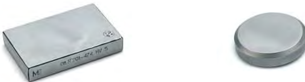
Рис.1 Внешний вид мер твёрдости эталонных Виккерса МТВ-МЕТ прямоугольной и круглой формы
