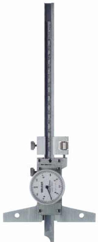
Рисунок 2 – Общий вид штангенглубиномеров серии 527 с отсчетом по круговой шкале
