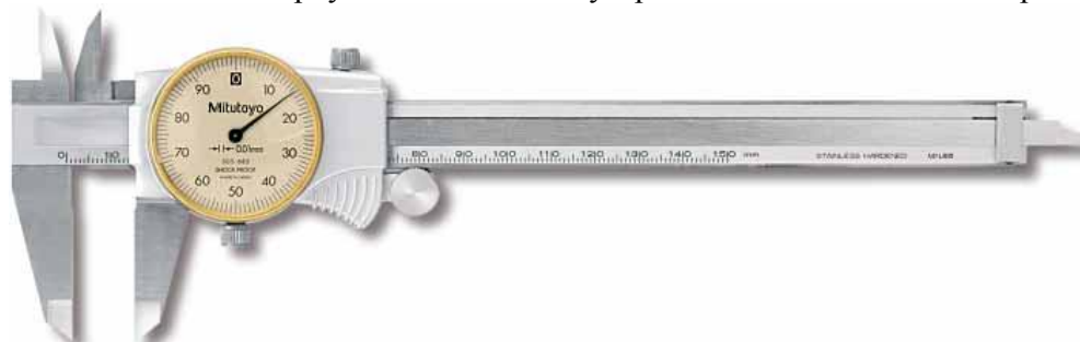
Рисунок 2 - Общий вид штангенциркулей с отсчетным устройством золотистого цвета серии 505
