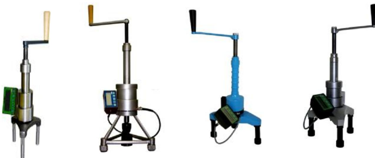
Рисунок 1 – Общий вид измерителей адгезии PCSO-MG4
