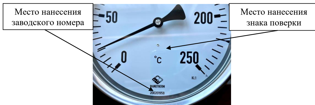
Рисунок 2 – Общий вид термометров биметаллических серии Т с указанием мест нанесения заводского номера и знака поверки.
