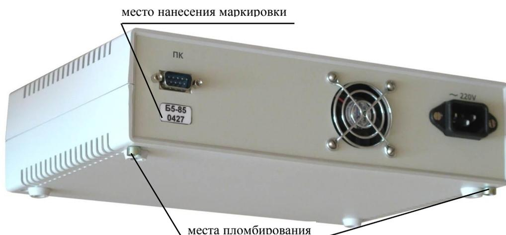
Рисунок 2 - Места пломбирования и нанесения маркировки
