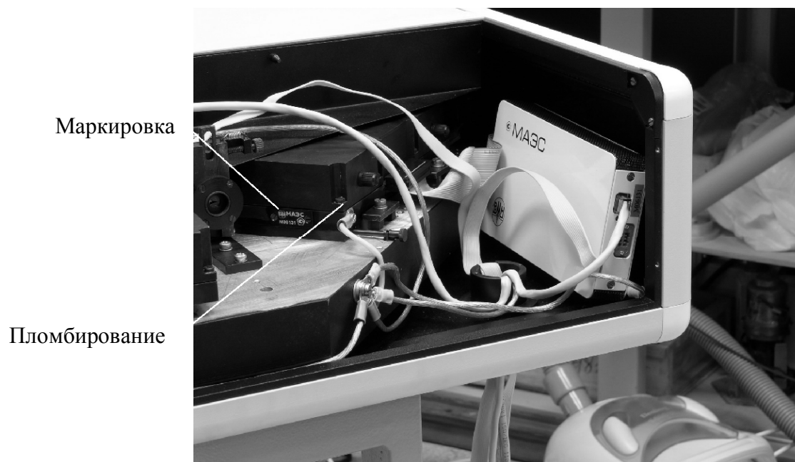
Рисунок 3 – Места нанесения маркировки и пломбирование
