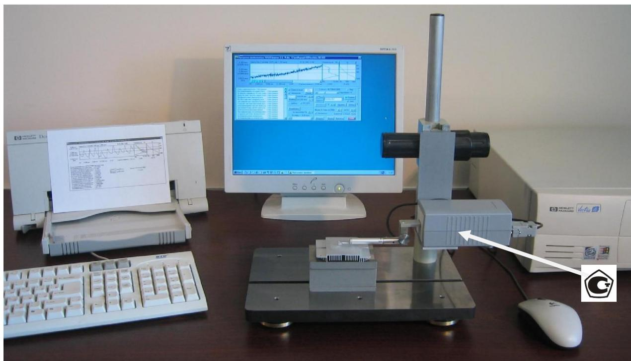
Рисунок 1 - Общий вид профилометра модели 130
