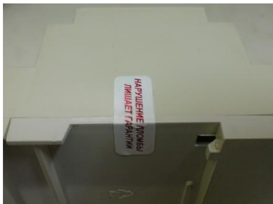
Рисунок 2 – Схема пломбировки блока управления
