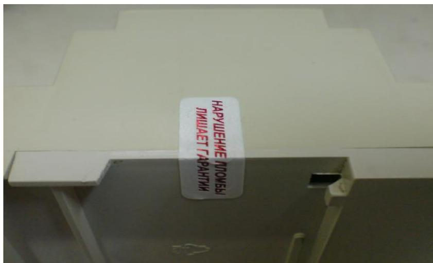
Рисунок 2 – Схема пломбировки блока управления
