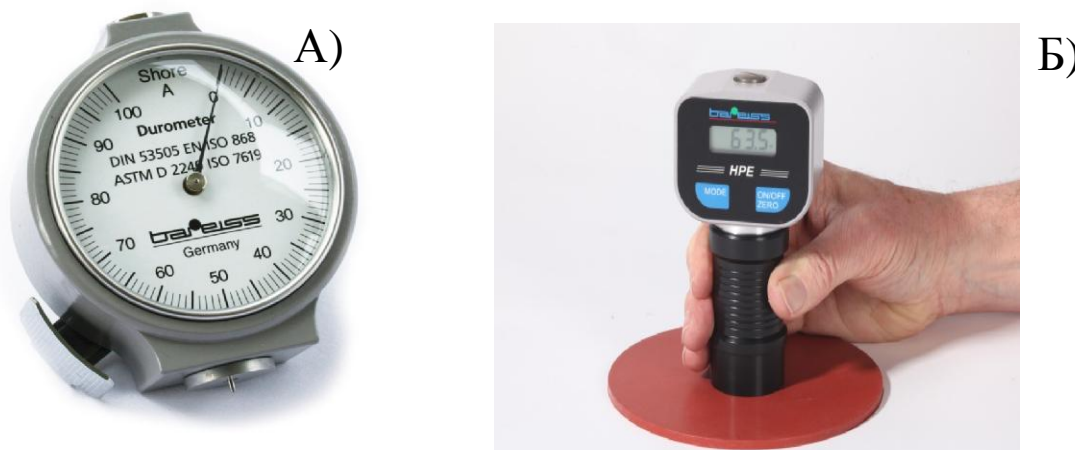
Рисунок 1 - Внешний вид твердомеров HP-D, HP-DS - А), HPE II Shore D - Б)
