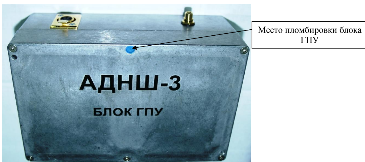
Рисунок 2 - Схема пломбировки от несанкционированного доступа
