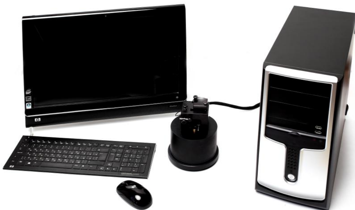
Рис. 1. Общий вид микроскопа saniрующего зондового ФемтоСкан
