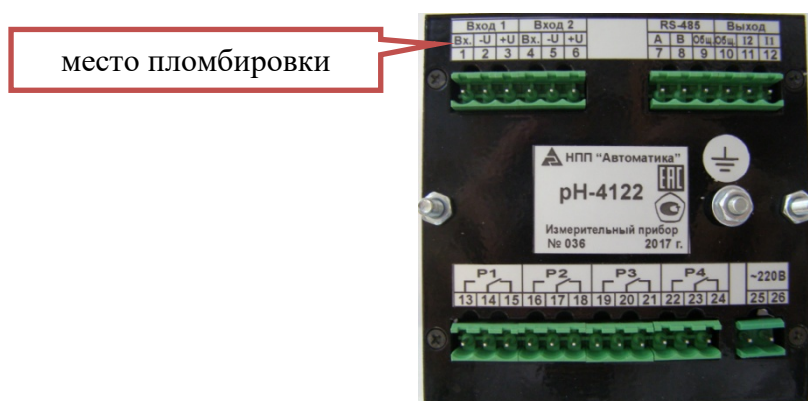
Рисунок 7 - Схема пломбирования рН-4121
