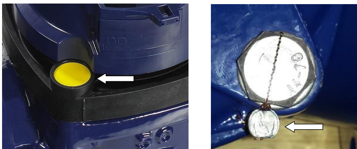
Рисунок 2 – Схема пломбировки от несанкционированного доступа, обозначение места нанесения знака поверки счетчиков холодной и горячей воды турбинных Meistream
