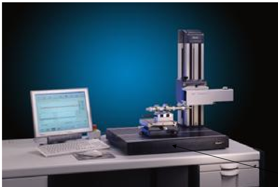
Рисунок 1 – Общий вид прибора для измерений шероховатости поверхности MarSurf XR 20 и место нанесения знака утверждения типа
