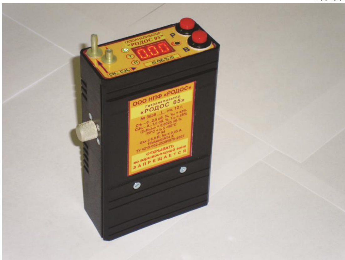
Рис. 1 Фотография общего вида газоанализатора РОДОС 05
