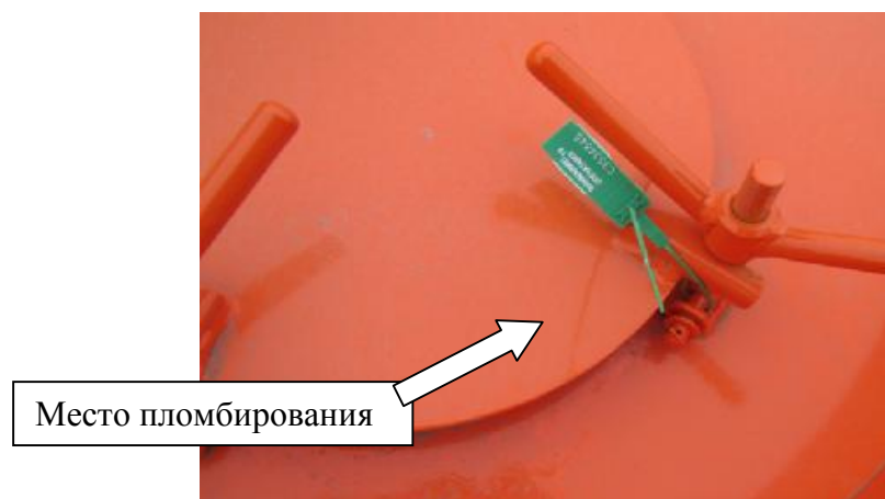
Рисунок 3 - Запорный механизм крышки заливной горловины АТЗ
