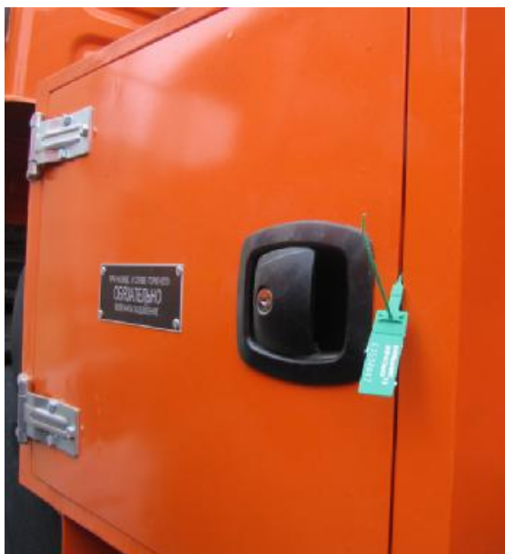
Рисунок 6 - Отсек для размещения узла выдачи топлива АТЗ
