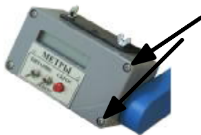
Рисунок 3 — Места установки пломб изготовителя
