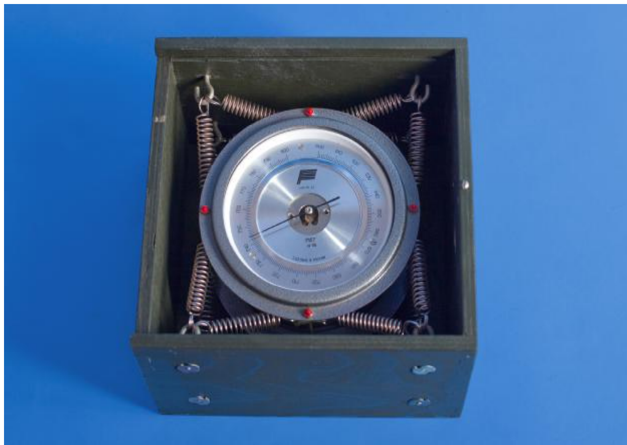
Рисунок 1 - Барометр-анероид контрольный М-67
