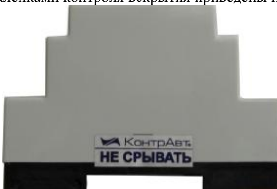
Рисунок 2 – Защита модулей от несанкционированного вскрытия с помощью одноразовых гарантийных наклеек контроля вскрытия
