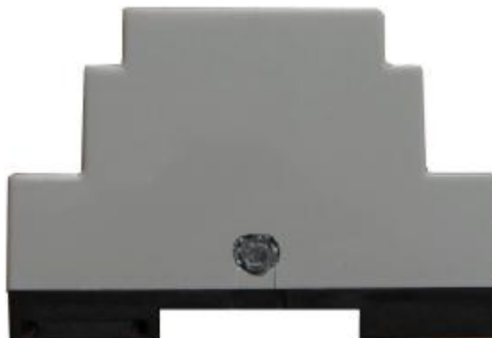
Рисунок 3 – Схема пломбировки модулей от несанкционированного доступа с помощью поверительного клейма
