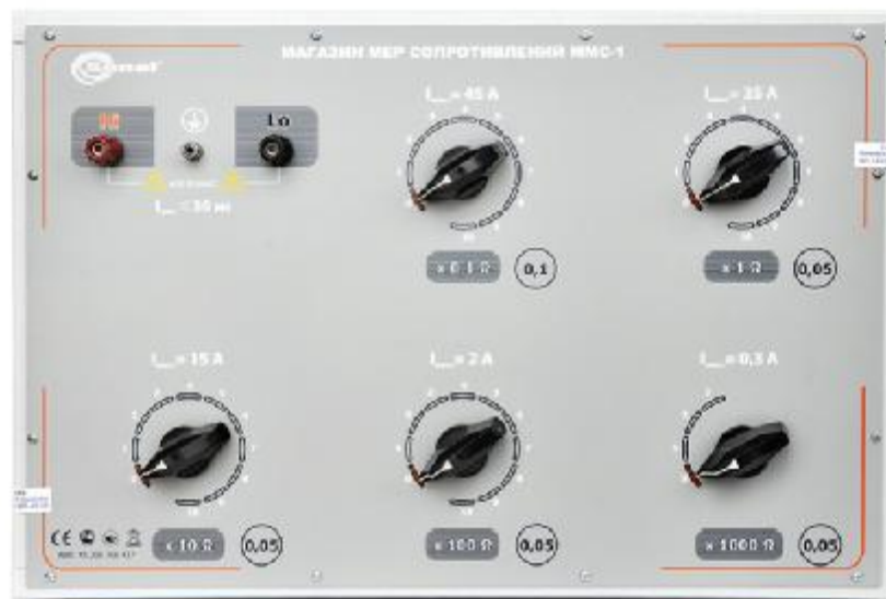
Рисунок 1 – Фотография общего вида магазинов мер сопротивлений петли короткого замыкания ММС-1
