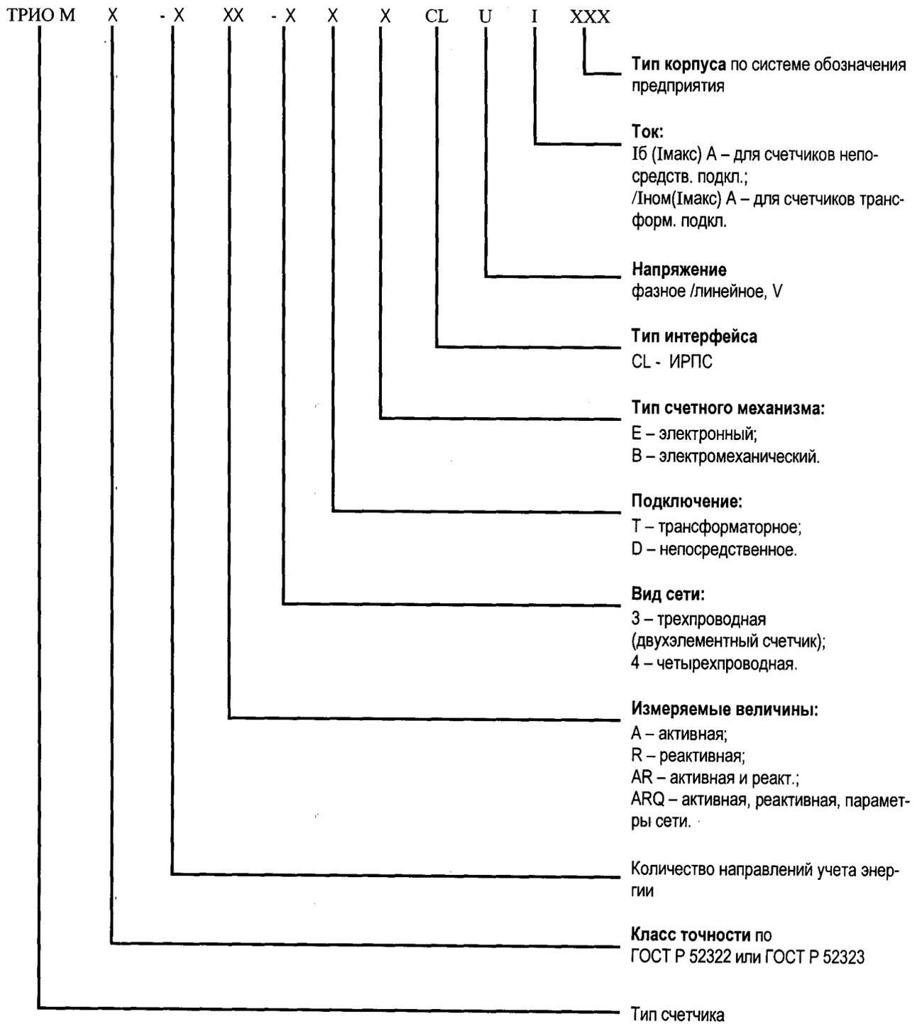
**Примечание** – маркировка варианта исполнения счетчика на щитке может не содержать информации, являющейся очевидной на образце или представленной на щитке в другом виде
