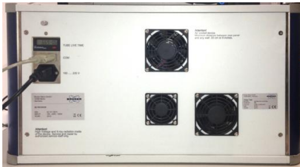
Рисунок 2- Задний план спектрометра рентгенофлуоресцентного S2 PICOFOX *-место маркировки, **- место пломбирования
