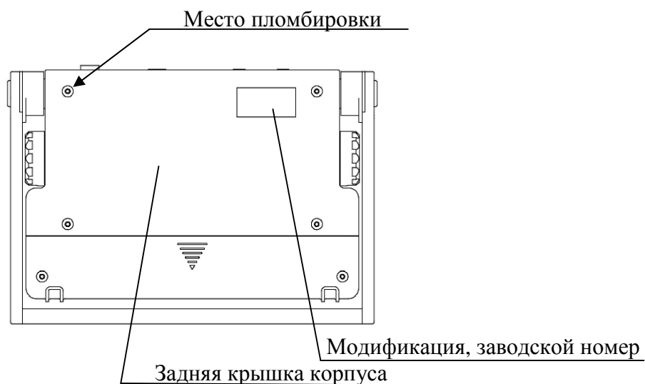
Рисунок 3 - Схема пломбировки корпуса дефектоскопа
