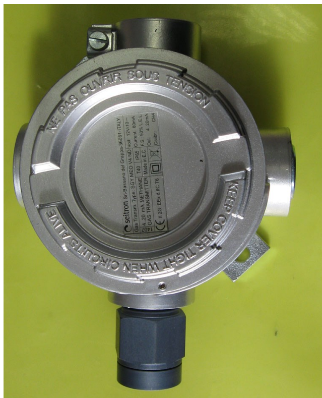
Рисунок 1 – Общий вид датчика метана SGY ME0 V4 ND
