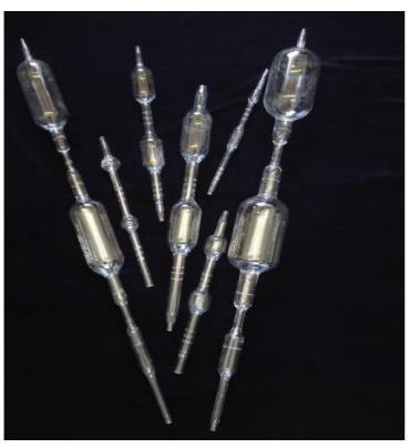
Пипетка собой представляет стеклянную трубку с расширенной средней частью в форме цилиндра. Нижняя часть трубки – сливной кончик имеет конусообразную форму. Нижняя кромка пипетки соответствует нулевой отметке. На пипетке нанесены круговые отметки в плоскости, перпендикулярной оси пипетки. Все отметки имеют цифровые значения. Отметки соответствуют значениям вместимостей на поверяемом цилиндре с учетом допускаемого отклонения.
