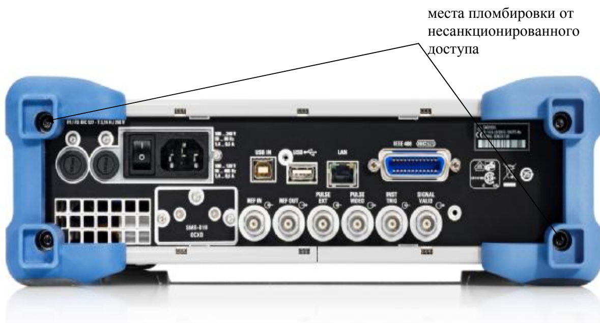
Рисунок 2. Схема пломбировки от несанкционированного доступа
