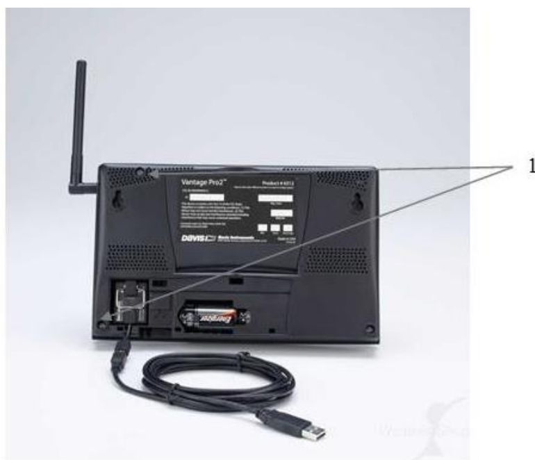
Рисунок 3 – Схема пломбирования станций Vantage Pro2 1 – место нанесения пломб
