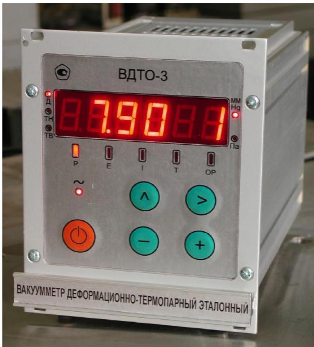
Рисунок 1 – Вакуумметр деформационно-термопарный эталонный ВДТО-3
