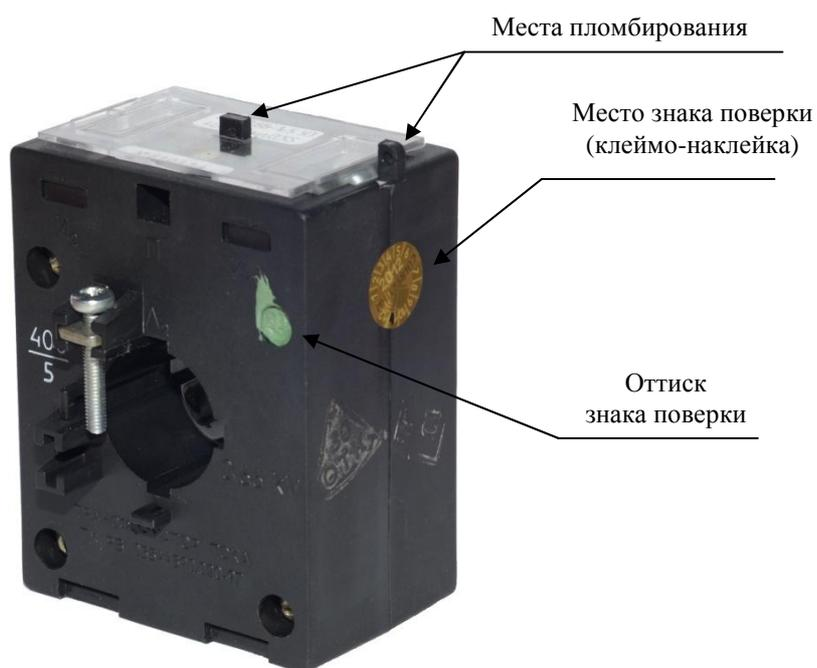
Рисунок 6 - Внешний вид трансформаторов тока ТСП-0,66У3 на первичные токи от 100 до 500 А
