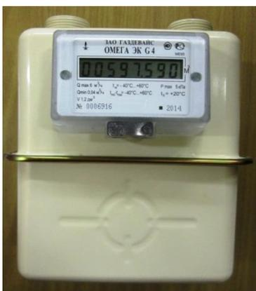
Рисунок 1 - Общий вид счетчика газа ОМЕГА ЭК
