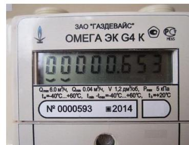
Рисунок 6 - Табличка счетчика газа ОМЕГА ЭК К
