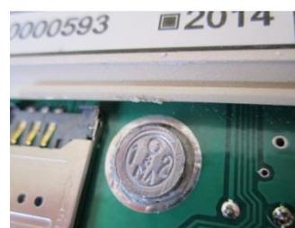
Рисунок 4 - Место пломбирования счетчика газа ОМЕГА ЭК К
