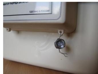
Рисунок 7 - Пломбирование крышки батарейного отсека ОМЕГА ЭК К
