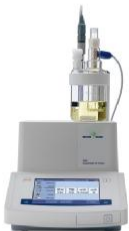
Рисунок 1 – Внешний вид титратора влаги по Карлу Фишеру автоматического моделей С20 и С30
