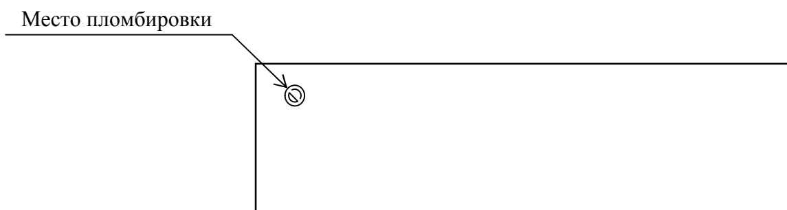
Рисунок 2 – Схема пломбировки от несанкционированного доступа
