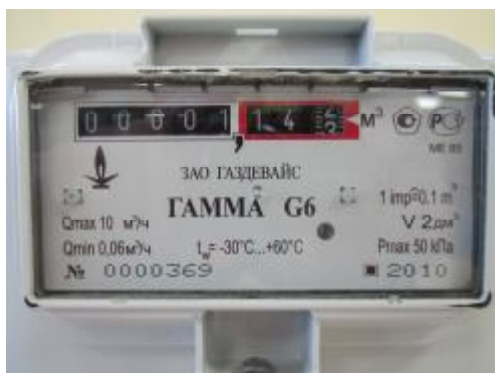
Рисунок 3 – Табличка счетчика газа ГАММА G6
