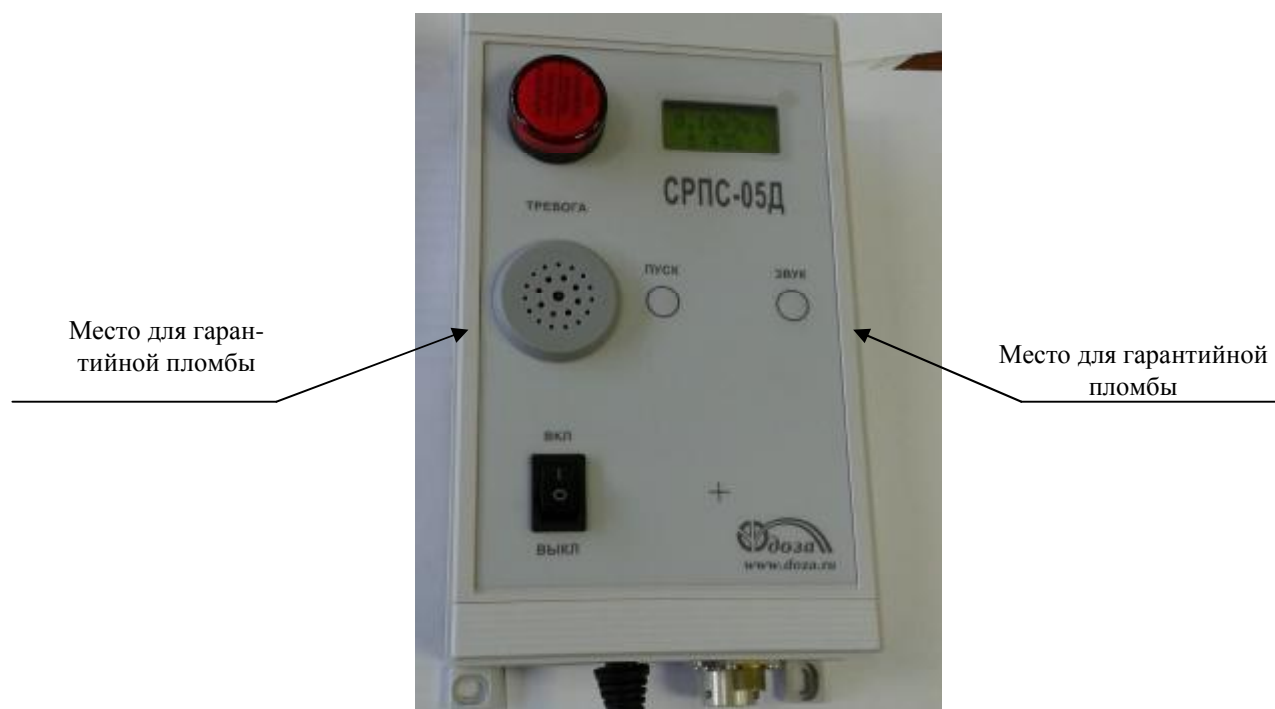
Рисунок 1 – Внешний вид и места пломбирования измерителя-сигнализатора
