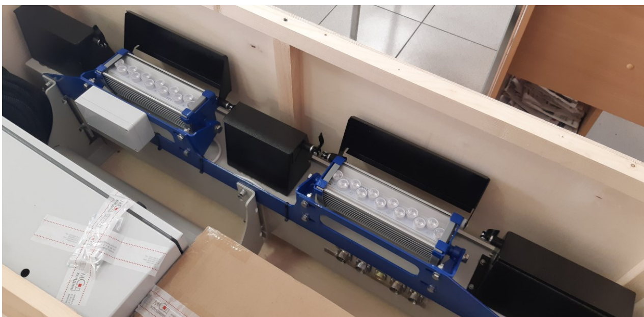
Рисунок 1 – Устройство слежения за параметрами контактного провода «Визир»
