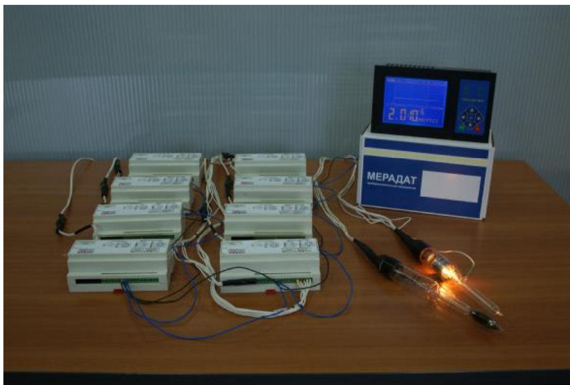
Вакуумметр Мерадат-ВИТ29 с тепловым и ионизационным первичными преобразователями, 1 основным и 8 вторичными измерительными блоками
