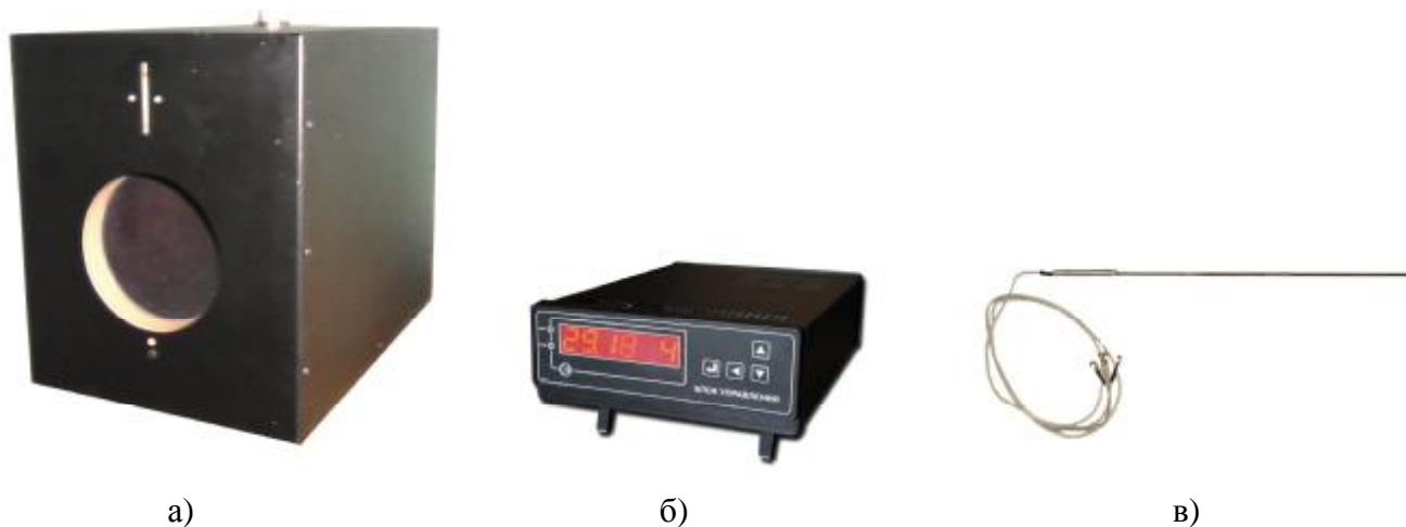
Рисунок 1 – Внешний вид излучателей: а) – тепловой излучатель; б) – блок управления; в) – эталонный термометр сопротивления.
